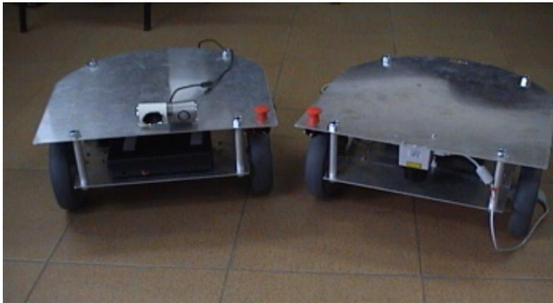
*Ilustración 6: RobEx primitivos, izquierda con cámara y derecha con láser.*
